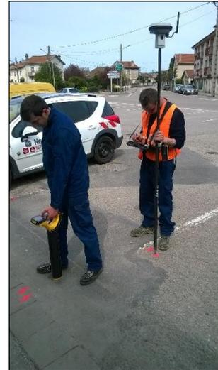
*Accès au poste de transformation Place de Trey pour la géo-localisation des réseaux souterrains en classe de précision A.*
